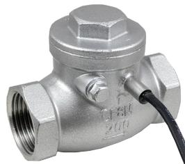
Принцип работы датчиков-реле основан на отклонении лепестка внутри прибора. Лепесток смещается под действием давления потока жидкости в трубе и замыкает контакты геркона. В случае отсутствия потока в трубе лепесток возвращается в исходное положение под действием силы тяжести, что приводит к размыканию контактов. Направление движения потока должно соответствовать стрелке на корпусе датчика-реле.
